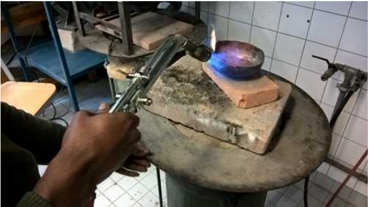
Eine getriebene Schale wird erhitzt um weiter bearbeitet zu werden.
