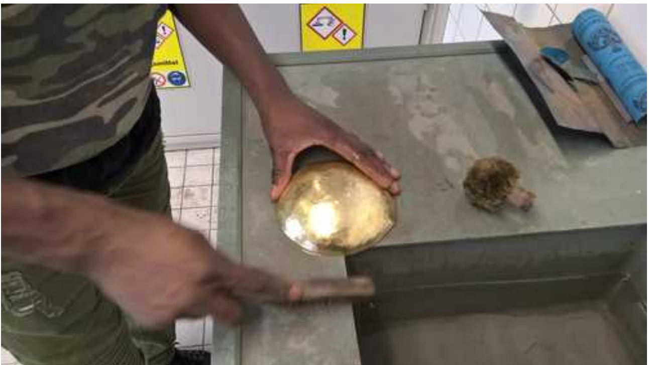
Waschen nach einem Säurebad das die Oxidation entfernt.
